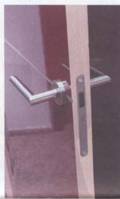
Falle wird mit einem Magneten herausgezogen: damit kann auf das Schließblech verzichtet werden
